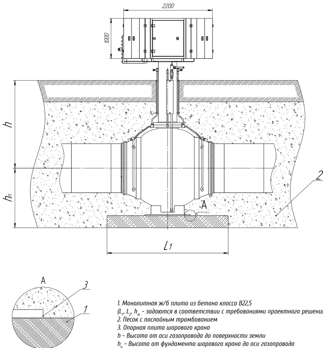
1. Монолитная ж/б плита из бетона класса В22,5
