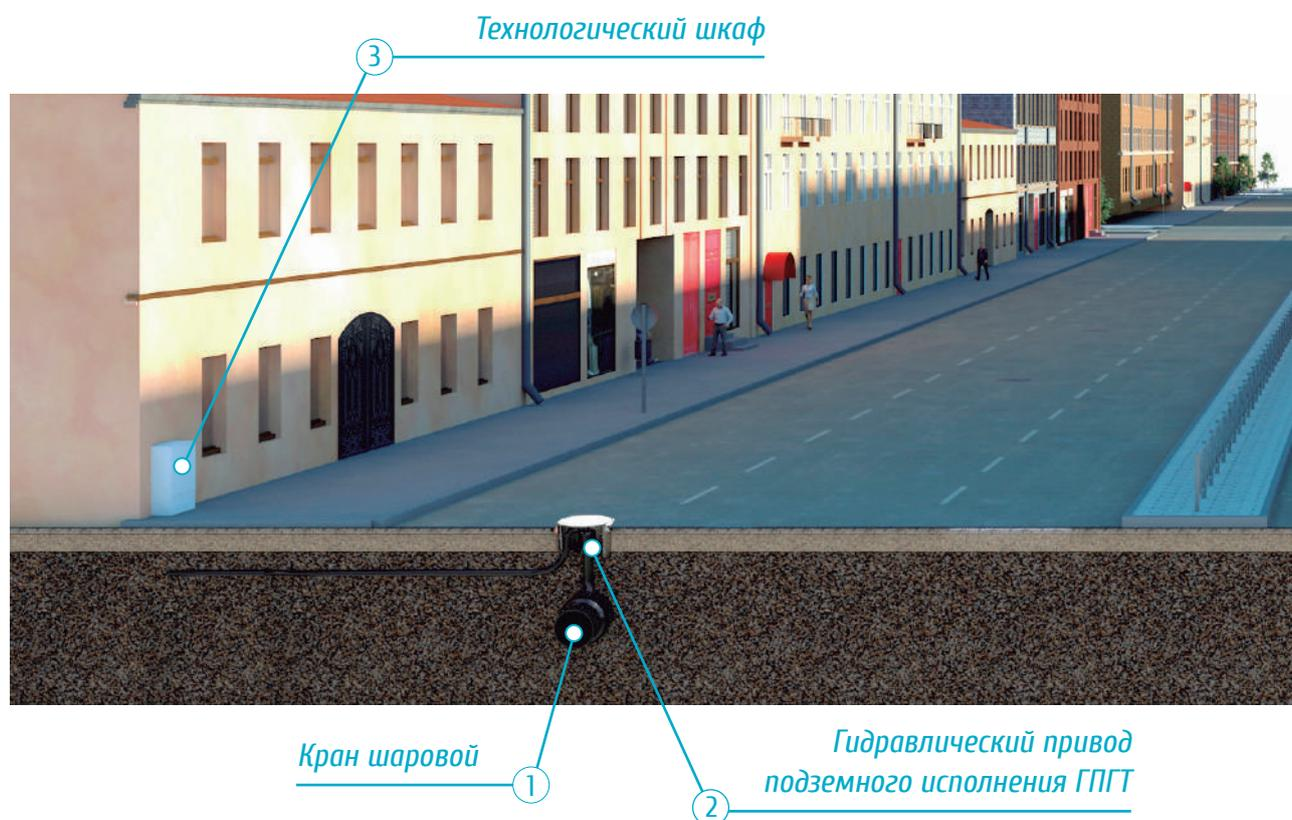
Рис. 3 - Состав ПТК МАК-АНТ с приводом подземного исполнения
