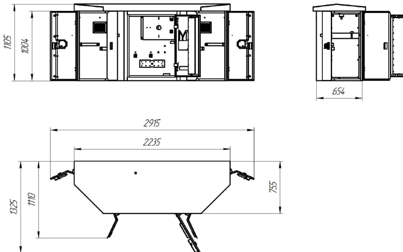
Рис. 6.5 - Максимальные габаритные размеры технологического шкафа ПТК МАК-АНТ магистрального исполнения
