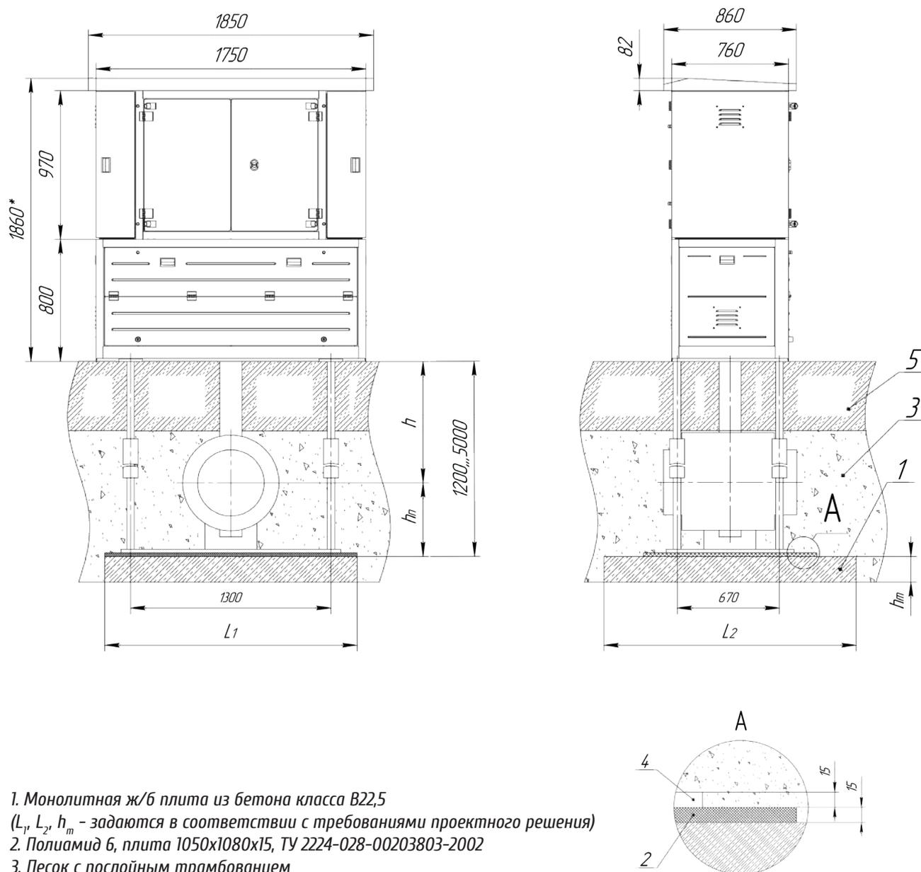
1. Монолитная ж/б плита из бетона класса В22,5
