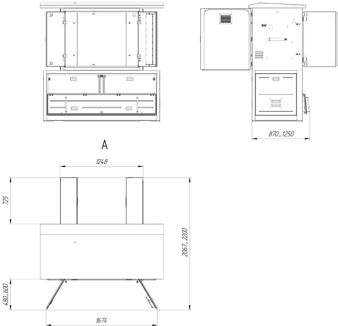
Рис. 6.2 - Максимальные габаритные размеры технологического шкафа ПТК МАК-АНТ с пневмогидравлическим приводом
