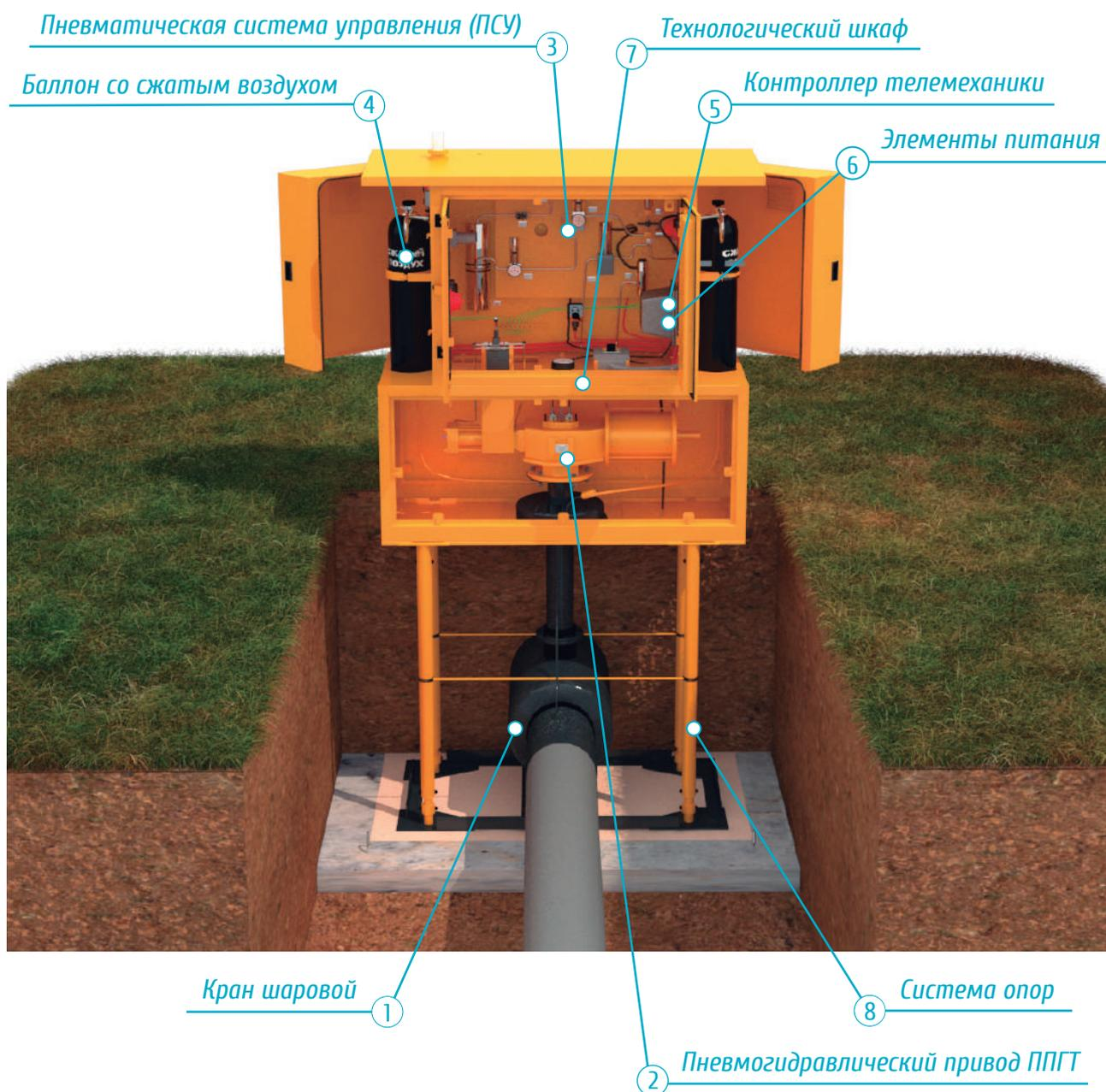
Рис. 3 - Состав ПТК МАК-АНТ с пневмогидравлическим приводом
