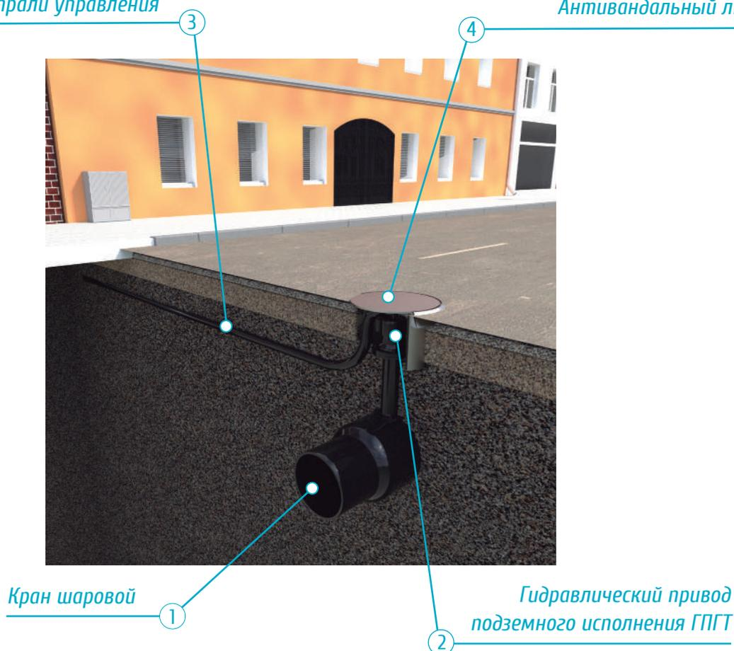
Рис. 4 - Подземная часть ПТК МАК-АНТ с приводом подземного исполнения
