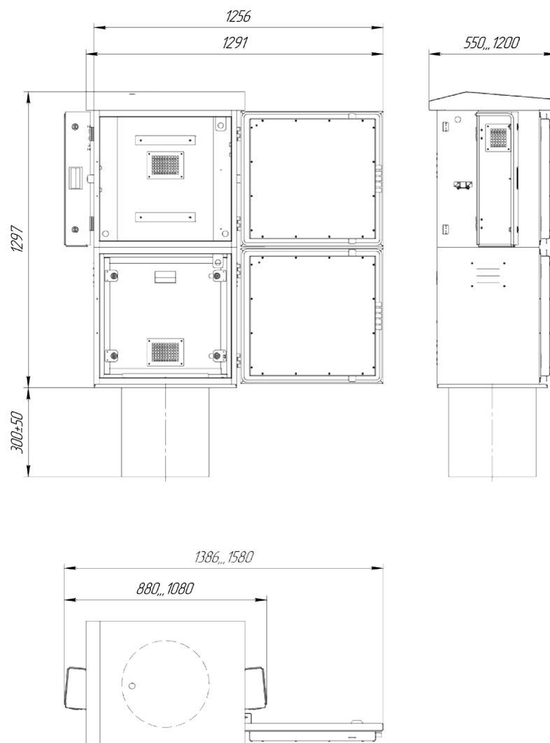
Рис. 5.1 – Максимальные габаритные размеры технологического шкафа ПТК МАК-АНТ с электрическим приводом
