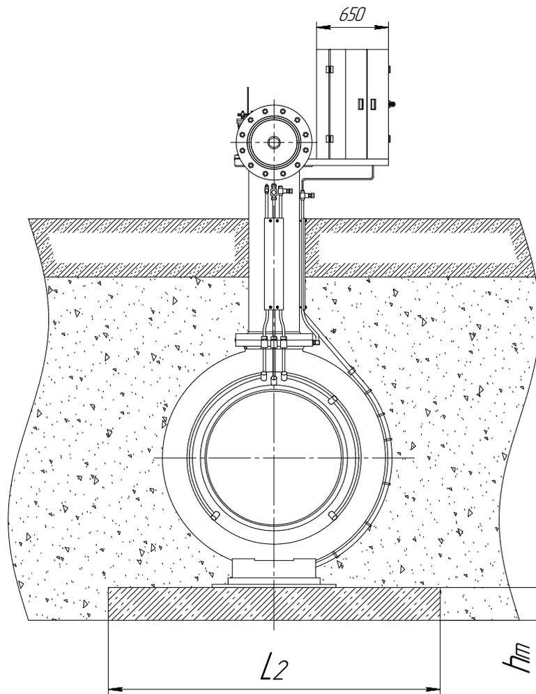
Рис. 6.4 - Габаритные и установочные размеры ПТК МАК-АНТ магистрального исполнения
