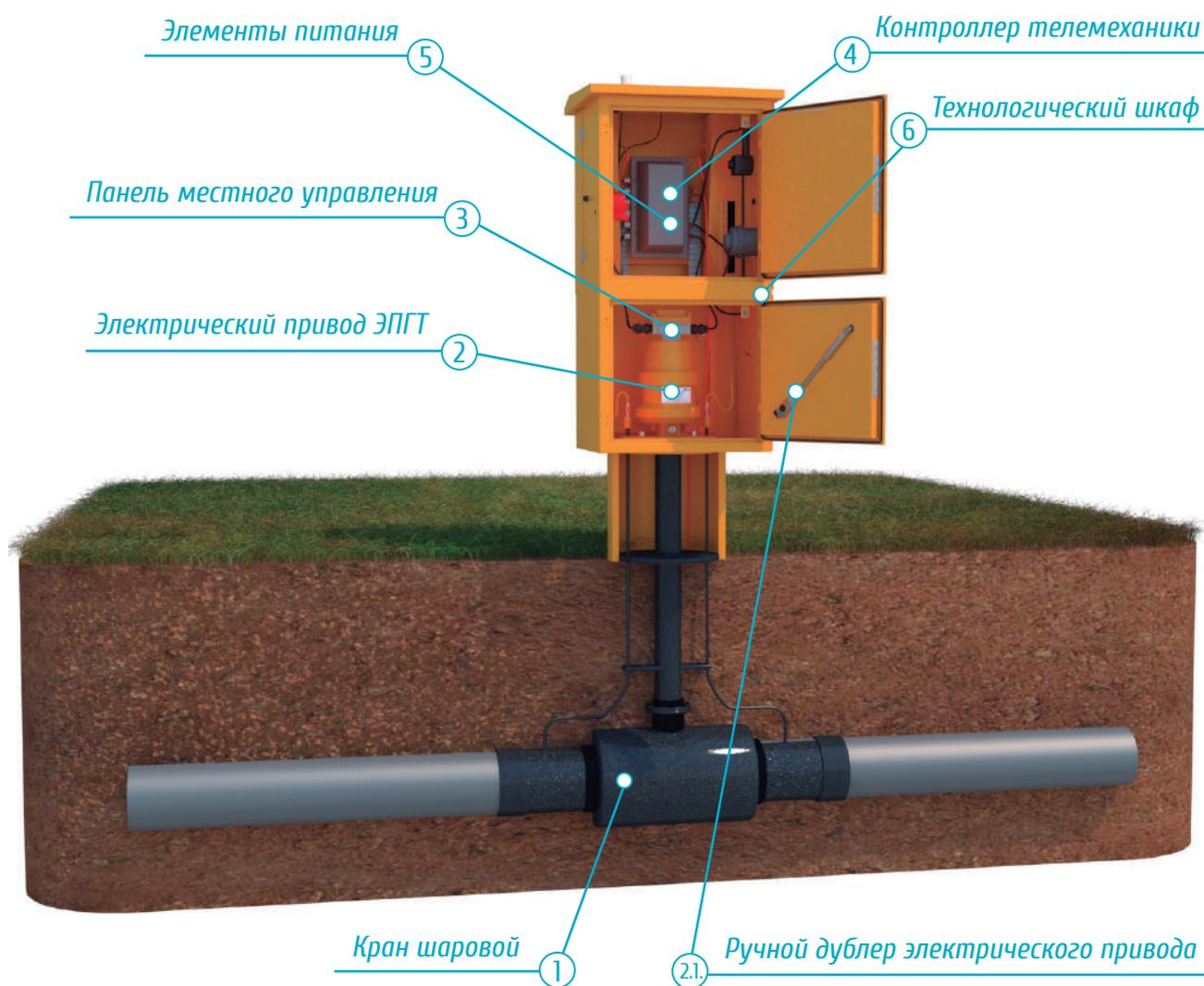
Рис. 3 – Состав ПТК МАК-АНТ с электрическим приводом
