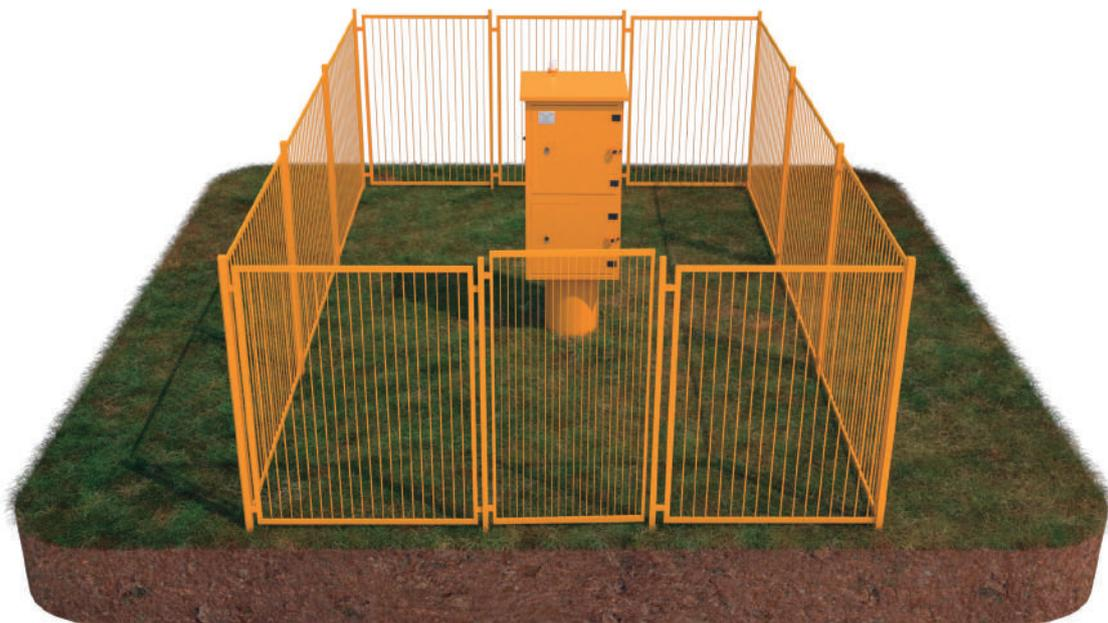
Рис. 6 - Общий вид площадки кранового узла после монтажа ПТК МАК-АНТ с электрическим приводом
