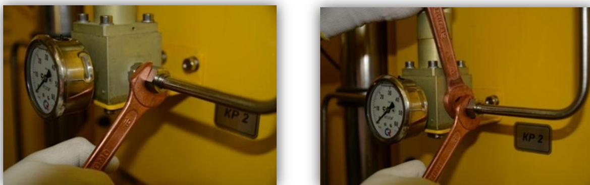
Рисунок 9. Пример затяжки гаек трубопроводов с помощью стопорного ключа
