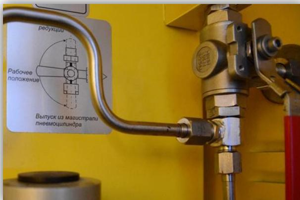
Рисунок 15. Положение рукоятки УВ «Выпуск из магистрали пневмоцилиндра»
