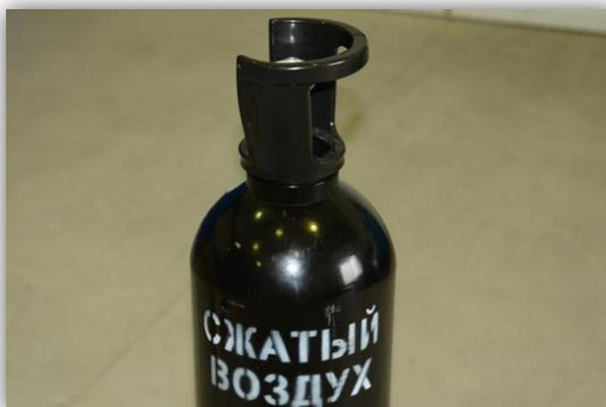
Рисунок 7. Источник сжатого воздуха с защитным колпаком-ручкой
