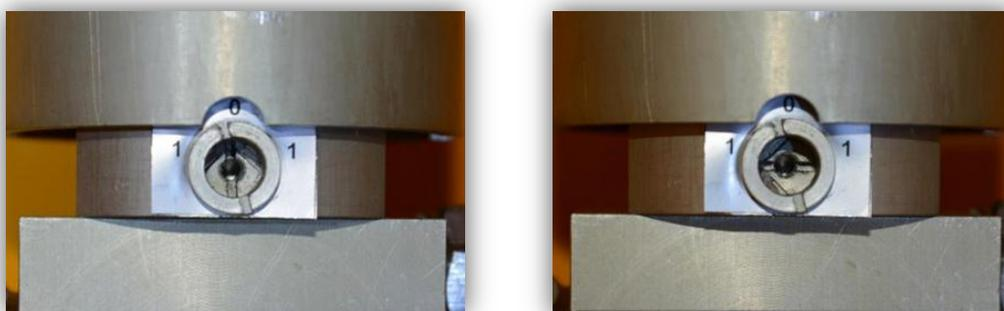
Рисунок 13. «Положение 0» и «Положение 1» ручного дублера РК
