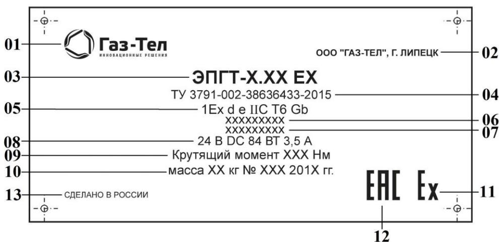
Рисунок 8. Общий вид типового шильдика
