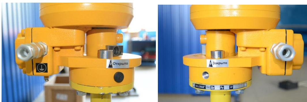
Рисунок 5. Визуальная индикация положения запорной арматуры.
